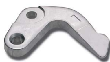
Fanghaken aus C 45 Dicke 15 mm Originalmaß - 50 x 28 mm
