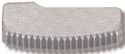
Feinverzahnung Maße: Modul 0,3 bei 3 mm Dicke Material: 42CrMo4
